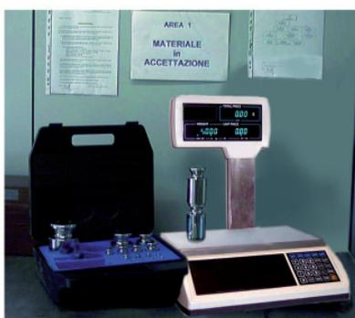
← Prova di eccentricità su bilancia elettronica da 12 kg
